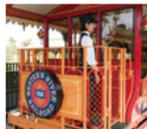
柵を設置し、 安全性が向上
